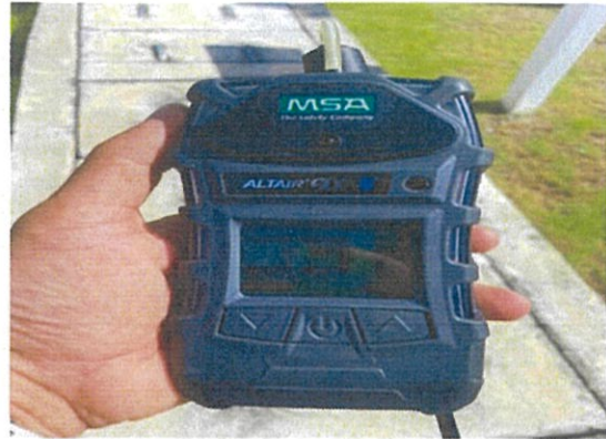
ตรวจสอบการรั่วไหลของก๊าซปกติ
